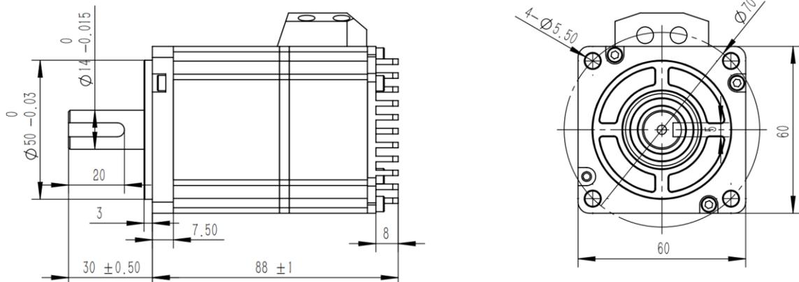
图 1-4 UM6020C-2BB0A 安装尺寸图 (mm)
