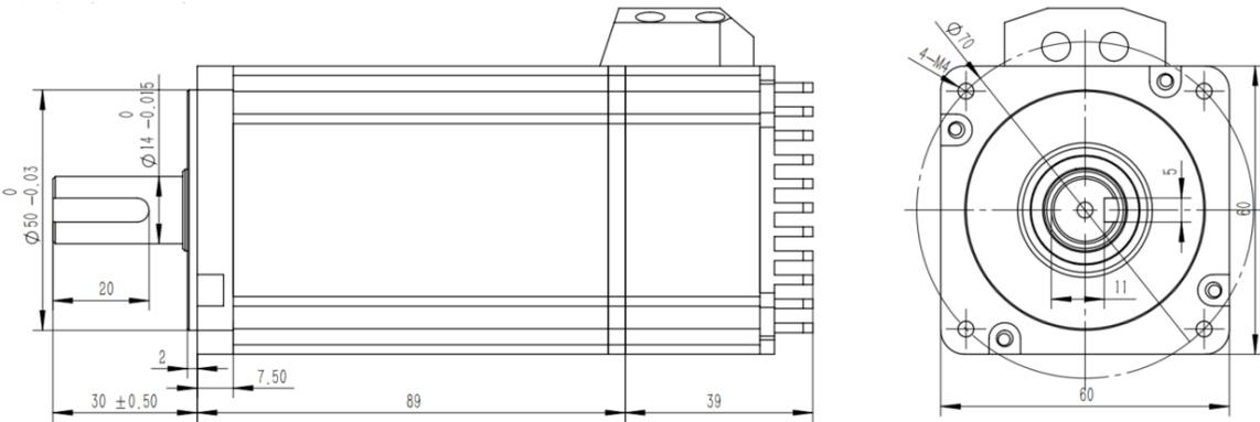
图 1-7 UM6040C-2BB0A-G 安装尺寸图 (mm)
