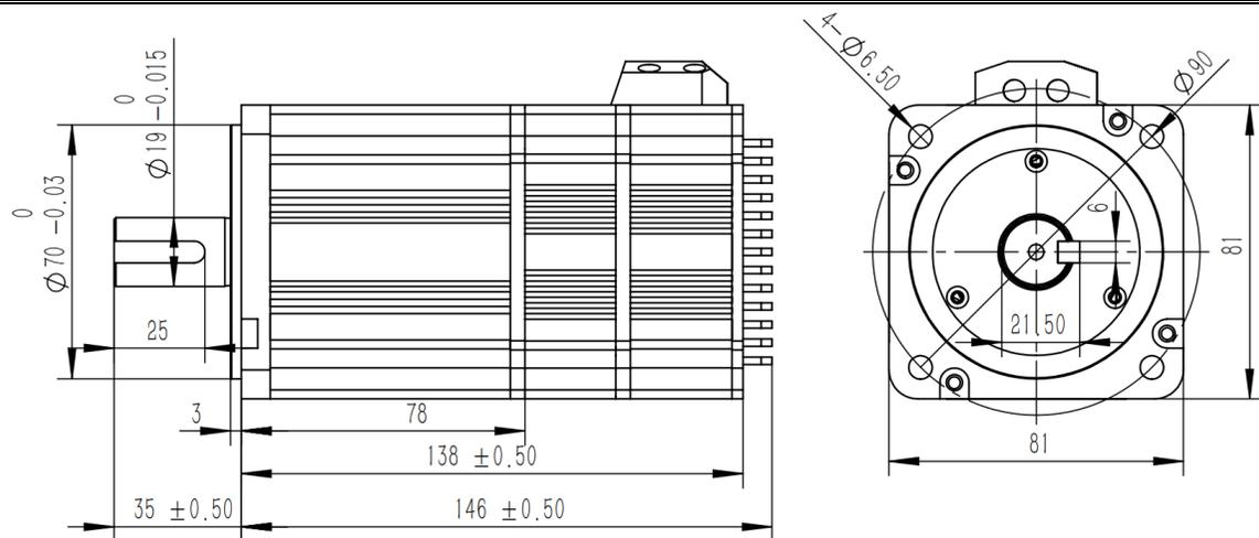
图 1-12 UM8075C-2BB0A-G 安装尺寸图 (mm)
