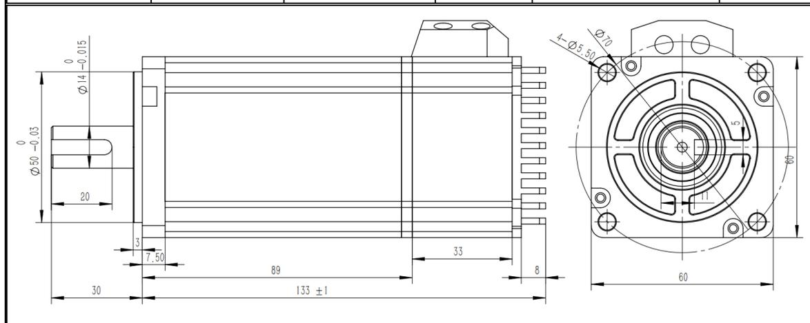
图 1-10 UM6040C-2ED1A-G 安装尺寸图 (mm)
