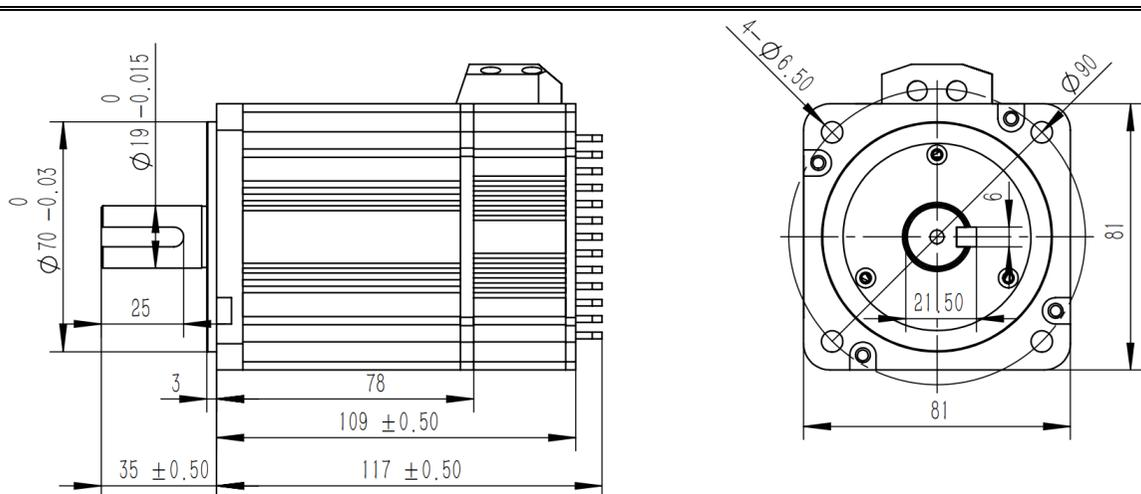
图 1-11 UM8075C-2BB0A 安装尺寸图 (mm)
