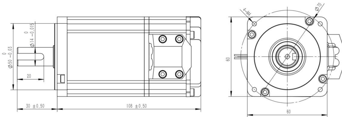
图 1-5 UM6020C-2BB0A-G 安装尺寸图 (mm)
