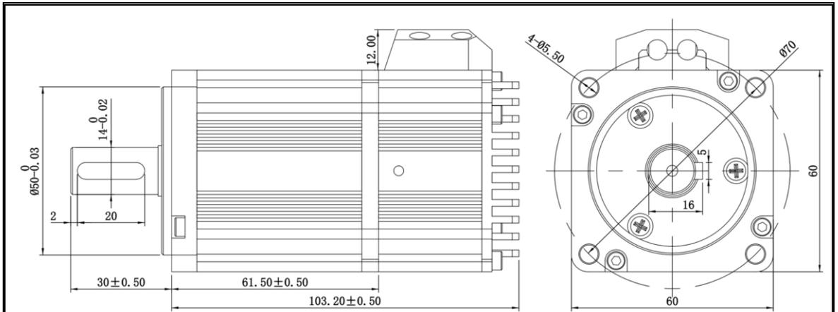
图 1-2 UM6020C-2AA0A 安装尺寸图 (mm)
