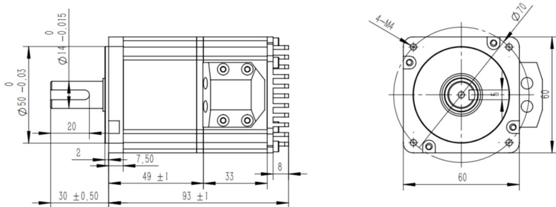
图 1-4 UM6020C-2DD1A 安装尺寸图 (mm)
