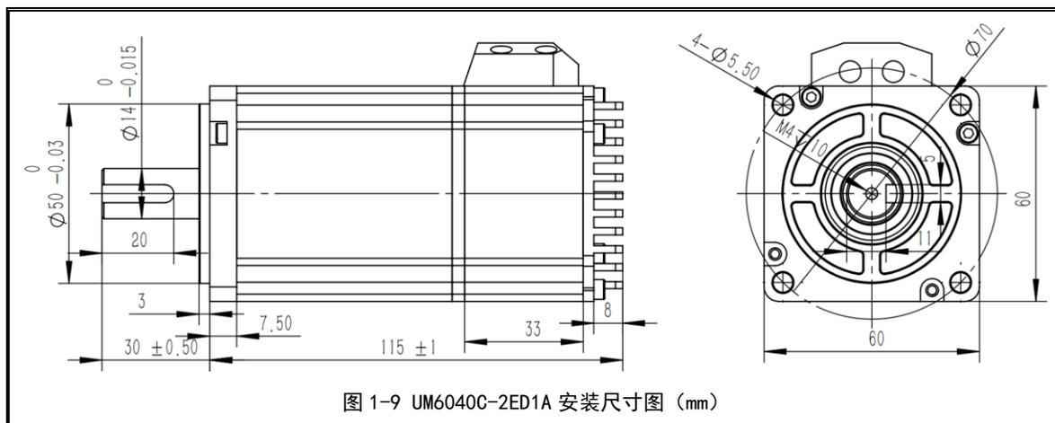
图 1-9 UM6040C-2ED1A 安装尺寸图 (mm)
