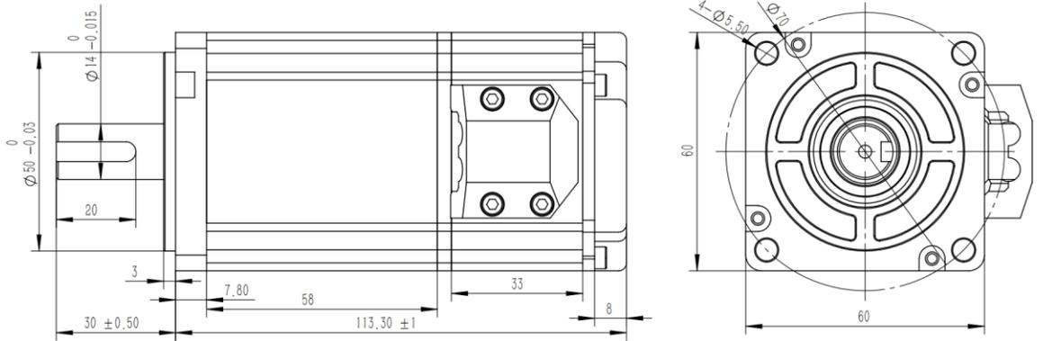
图 1-5 UM6020C-2ED1A-G 安装尺寸图 (mm)
