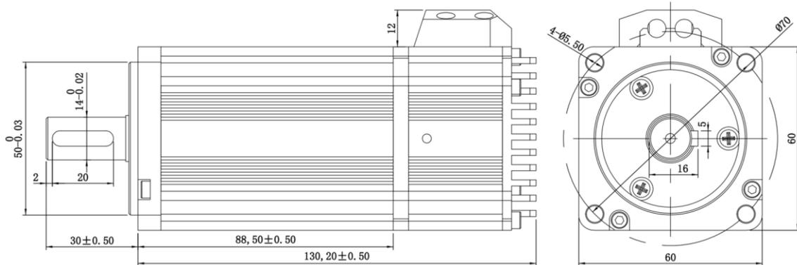
图 1-3 UM6040C-2AA0A 安装尺寸图 (mm)
