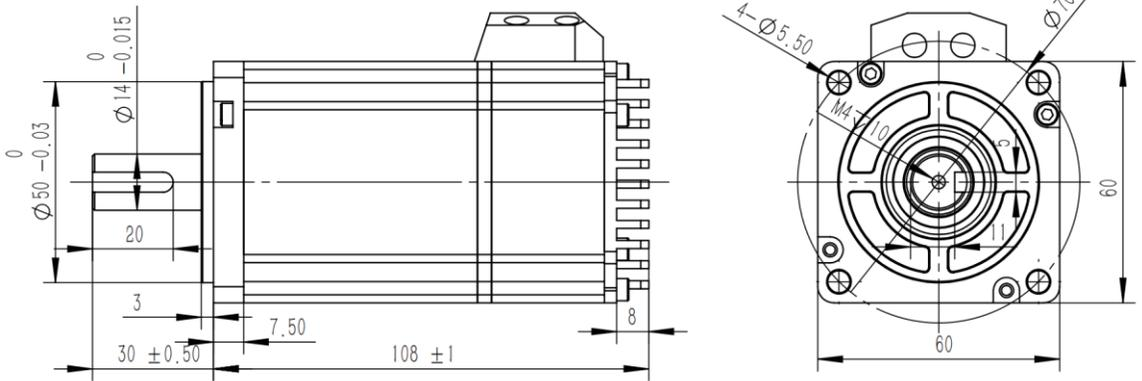
图 1-6 UM6040C-2BB0A 安装尺寸图 (mm)
