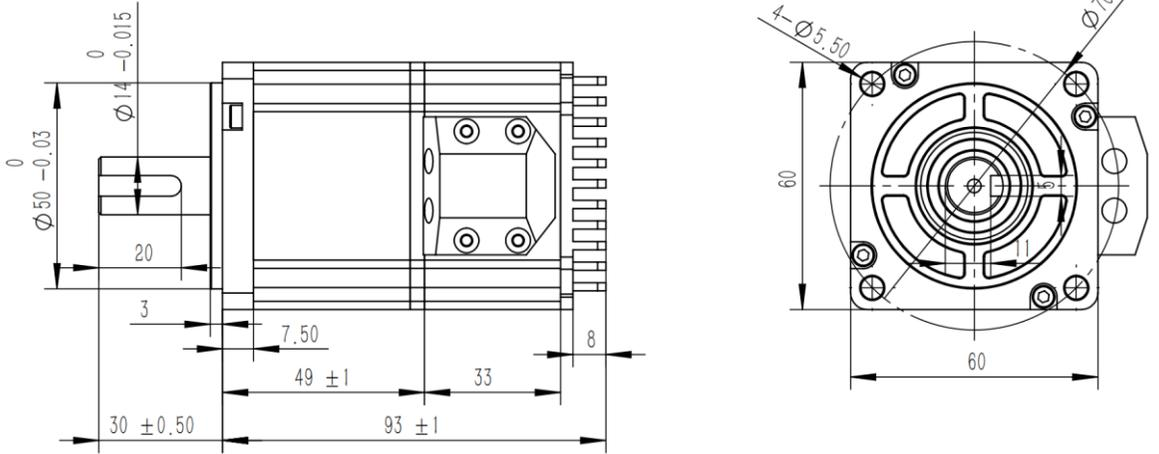
图 1-4 UM6020C-2ED1A 安装尺寸图 (mm)
