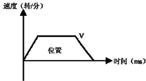
三种模式下，电机启停可以通过两种方式控制，第一种通过通讯设置开始运动 IO 寄存器（地址是 1）=ON 或者 OFF 来控制电机启停，第二种可以通过外部输入，控制启动输入信号光偶导通，电机开始运动，光偶截止电机停止运动。
